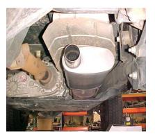
INSTALL MUFFLER # A ONTO FACTORY HEADPIPE USE CLAMP # C TO SECURE. DO NOT TIGHTEN. OUTLET OF MUFFLER SHOULD BE AT THE 9 O'CLOCK POSITION.
