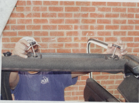
12. Unscrew door pins & remove frames.
